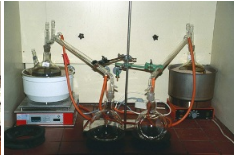
Bild 5: Destillation von Antimon im Sandbad. Foto: Olaf Rippe
